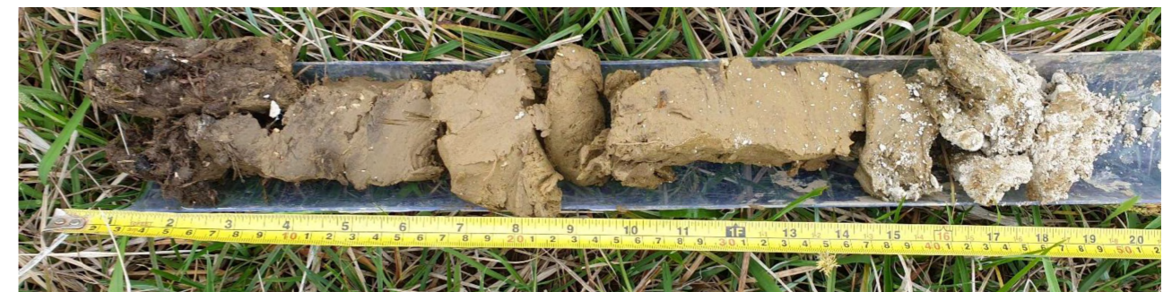
Sondage P3 montrant un horizon très argileux avant le calcaire
